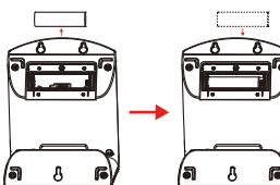
② Retire la batería vieja, cambie la batería nueva y conecte el electrodo positivo y negativo correctamente.
