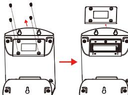
① Afloje los tornillos, abra la tapa de la batería.
