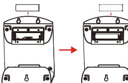
② Retire la batería vieja, cambie la batería nueva y conecte el electrodo positivo y negativo correctamente.
