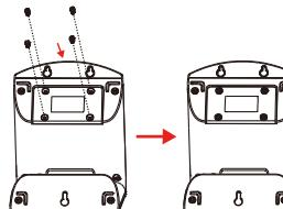
③ Luego vuelva a instalar la cubierta y bloquee los tornillos.
